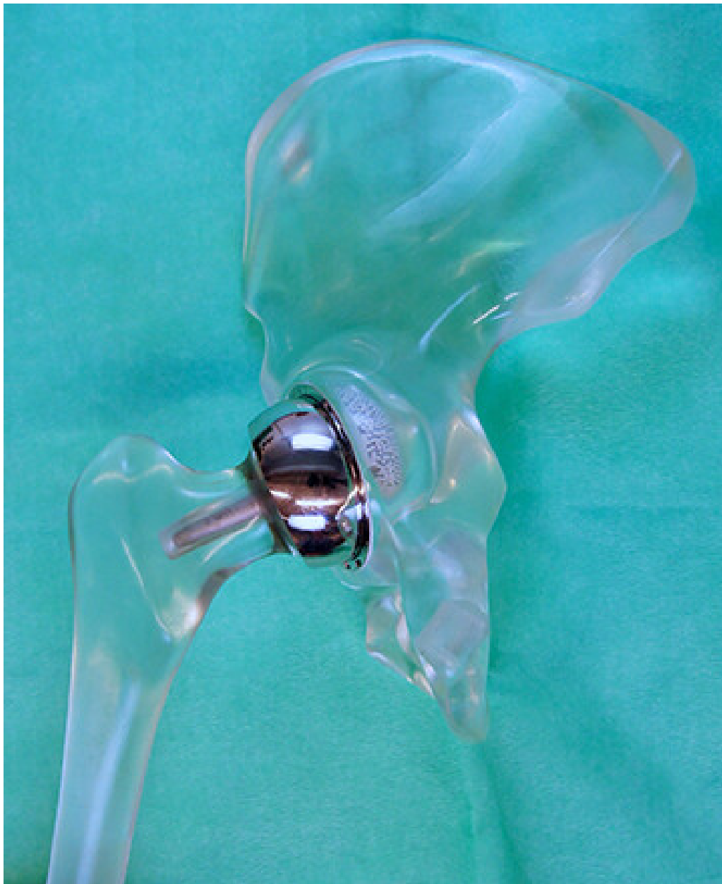
Figur 1 En Birmingham hip resurfacing -skallprotese (Smith and Nephew, Warwick, England), her satt inn i en hoftemodell, har metall-mot-metall-leddflater der «kopp» og «hode» består av en kobolt-krom-molybden-legering med 66 % Co, 26,5–30 % Cr, 4,5–7,0 % Mo, < 1 % Ni, Mn og Fe, og < 0,35 % C, i henhold til ISO-standard 5832. Bilderettigheter: Biomatlab, Haukeland universitetssjukehus.
