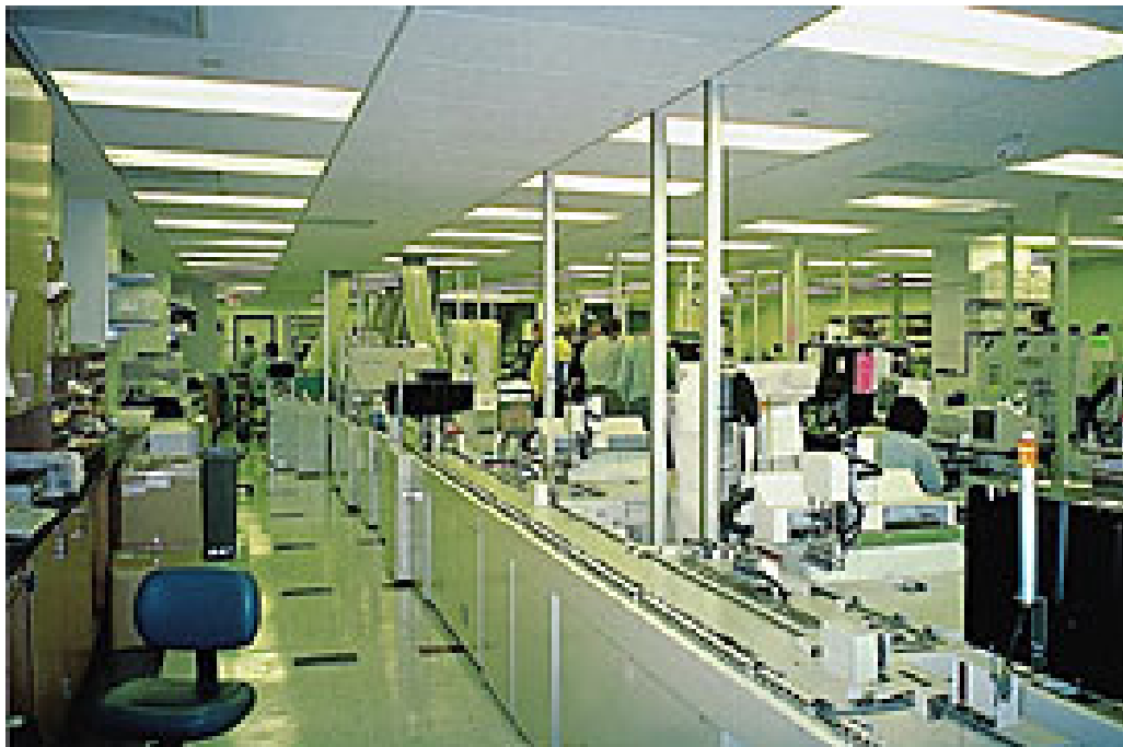
Figur 4 Utsnitt av transportbåndet fra kjernelaboratoriet ved Department of Pathology and Laboratory Medicine, Hospital of the University of Pennsylvania, Philadelphia, USA. Analysemaskinene er plassert vinkelrett på transportbåndet, inn til høyre. Foto A. Utaaker
