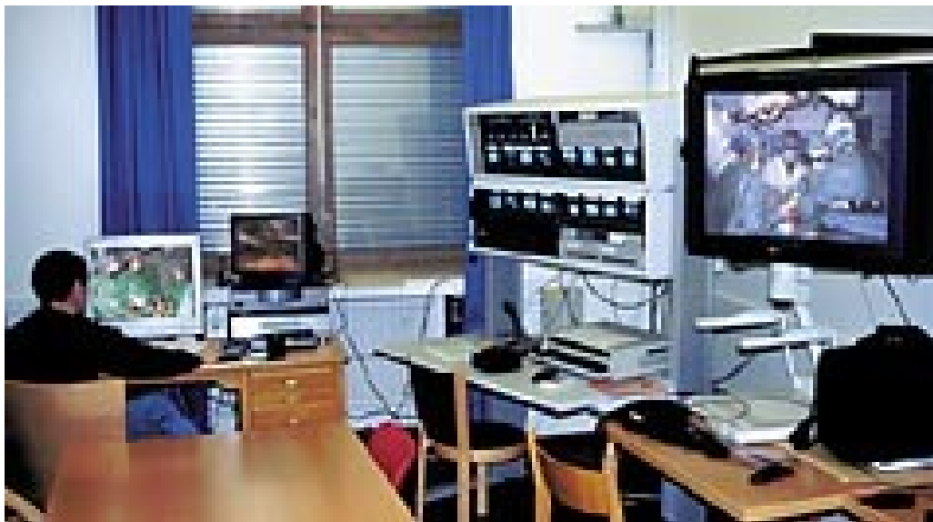
Figur 1 Kontrollrommet ved Intervensjonscenteret for telemedisinsk kommunikasjon. Overføring av inntil 16 skjermbilder og lydkommunikasjon fra operasjonsstuer eller auditorier kan kontrolleres for videresending (ISDN, ATM eller satellitt) eller for opptak til multimedieproduksjon
